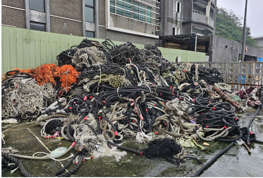
圖 2 颱風後往往造成鋼纜與繩索等斷裂、糾纏、或者應力不足等損毀
